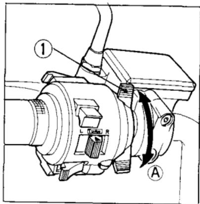
4. Tirer le levier de starter (1) à fond en arriere pour le mettre en position d'ouverture complète (A) si le moteur est froid.
