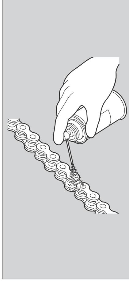
チェーンは、ゴムのシールを使用しているため、スチーム/高圧洗浄、ワイヤーブラシ、ガソリンやベンゼンなどの揮発性溶剤、研磨材が入っている洗剤は使用しないでください。
