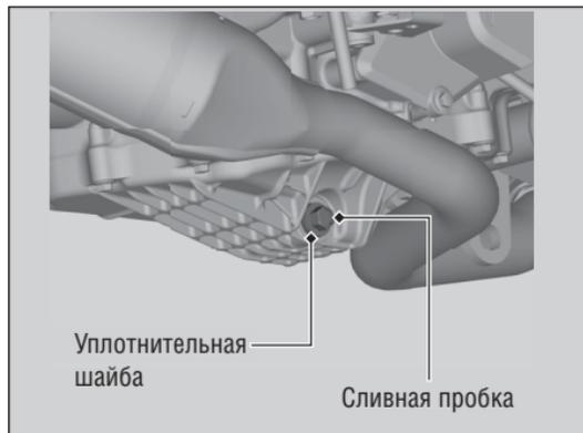
6. Для слива масла отверните пробку-щуп маслозаливной горловины, отверните сливную пробку с уплотнительной шайбой.
