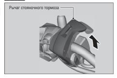
Установите мотоцикл на ровной горизонтальной площадке. Для проверки исправности стояночного тормоза остановите двигатель и попытайтесь толкнуть мотоцикл вперед при полностью вытянутом рычаге стояночного тормоза.
