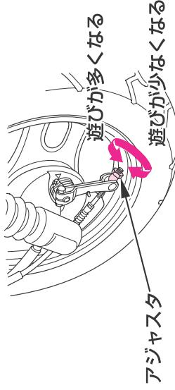
**2 後輪側のアジャスターを半回転ずつ回し、遊びを調整します。**
