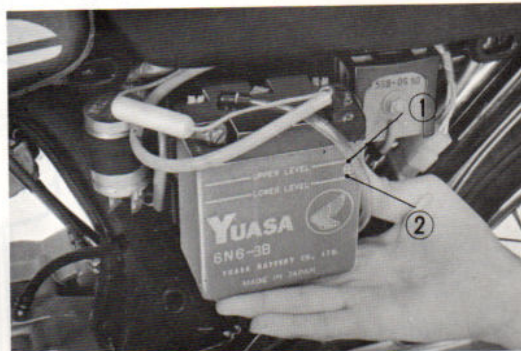
Fig. 24 ① Niveau supérieur ② Niveau inférieur
