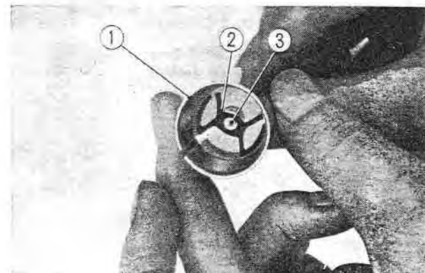
Fig. 6-5 ① Clapet de commande des gaz ② Plaque de retenue de l'aiguille ③ Aiguille de gicleur
