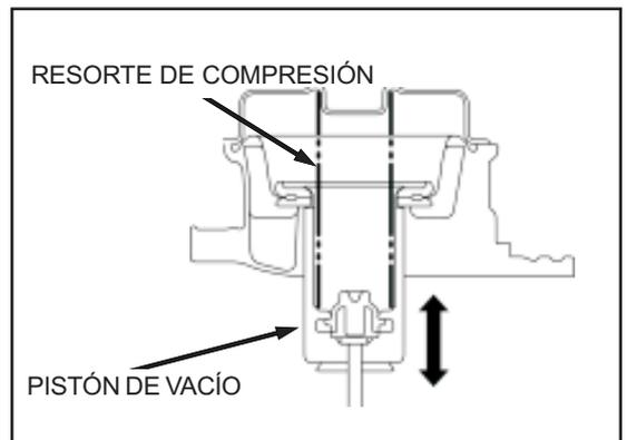
Monte el diafragma/pistón de vacío en el cuerpo del carburador alineando la orejeta del carburador con la ranura del aislador.
