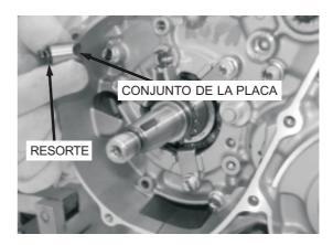
Desmonte el tornillo del cárter motor derecho.
