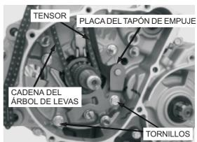
Desmonte el tornillo de la placa del tapón de empuje (4) y la placa del tapón de empuje.
