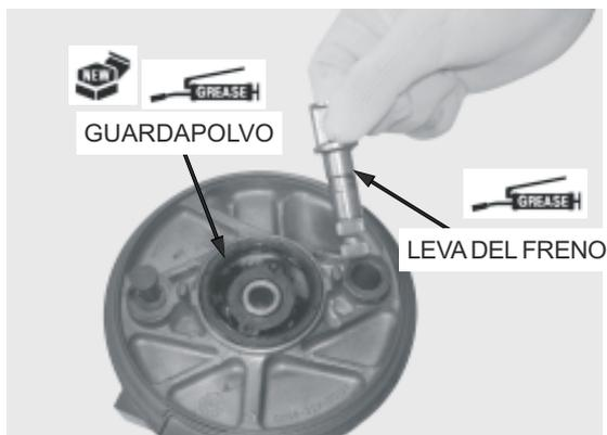
Aplique aceite de motor a la junta de fieltro nueva y móntela en el panel de freno.
