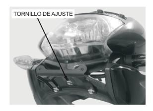
Desconecte el conector del faro.
