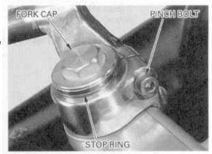
Loosen the top bridge pinch bolt.
