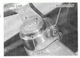
Loosen the top bridge pinch bolt.
