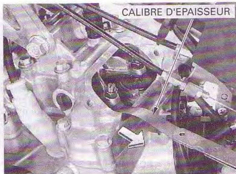
Pour régler, dévissez le contre-écrou et faites tourner la vis de réglage jusqu'à ce que vous sentiez un léger frottement sur le calibre d'épaisseur.
