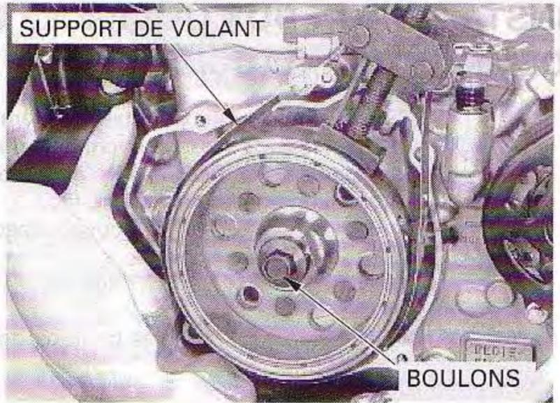
Déposez le volant à l'aide de l'extracteur de volant.
