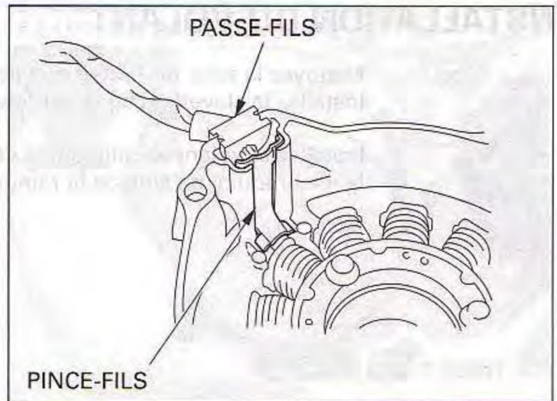
Déposez les boulons du stator et les boulons du générateur d'impulsions d'allumage. Déposez l'ensemble stator/générateur d'impulsions d'allumage.
