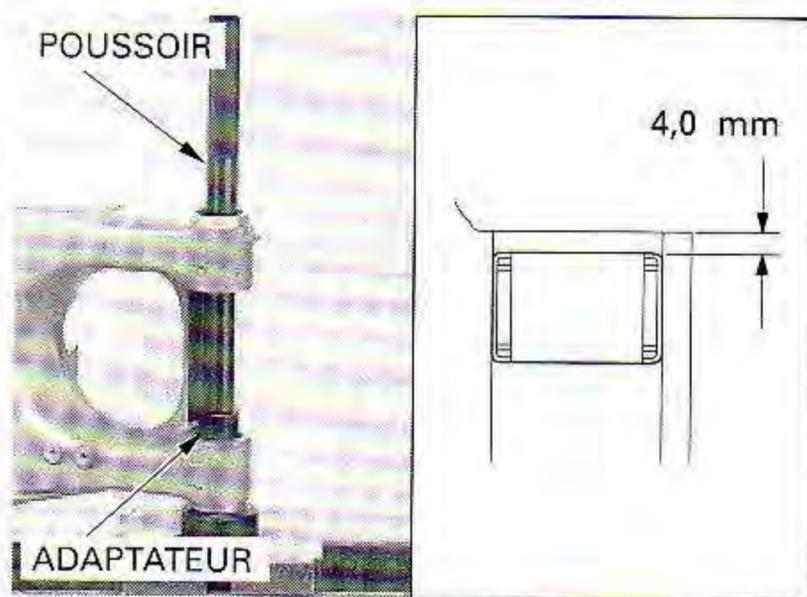
*Forcer les roulements à aiguilles dans le basculeur, côté repère tourné vers l'extérieur.*
