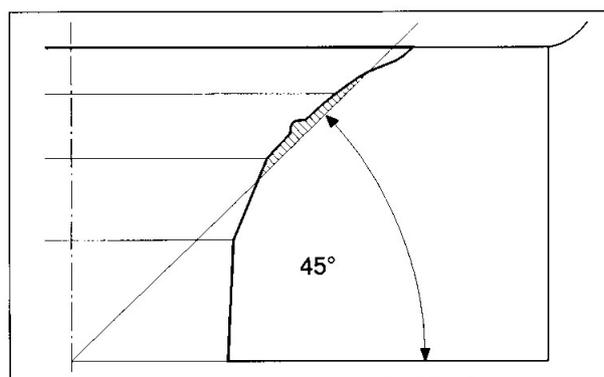
Utilizando uma fresa de 32°, remova 1/4 do material da sede.
